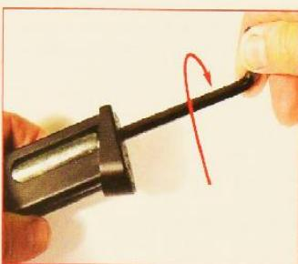
Затяните винт, находящийся в нижней части магазина. Когда давление в магазине начнет увеличиваться (можно услышать, как из баллона выходит газ), немедленно переставайте закручивать. **ОЧЕНЬ ВАЖНО:** не закручивайте слишком сильно, это обязательно приведет к повреждению уплотнения под баллон.
