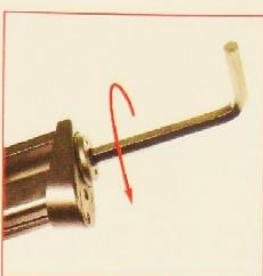
Выверните винт, находящийся в нижней части магазина при помощи ключа, входящего в комплект
