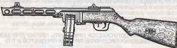
Рисунок 1 - Винтовка пневматическая газобаллонная модели «ППШ-М» калибра 4,5 мм с дульной энергией менее 3,0 Дж
